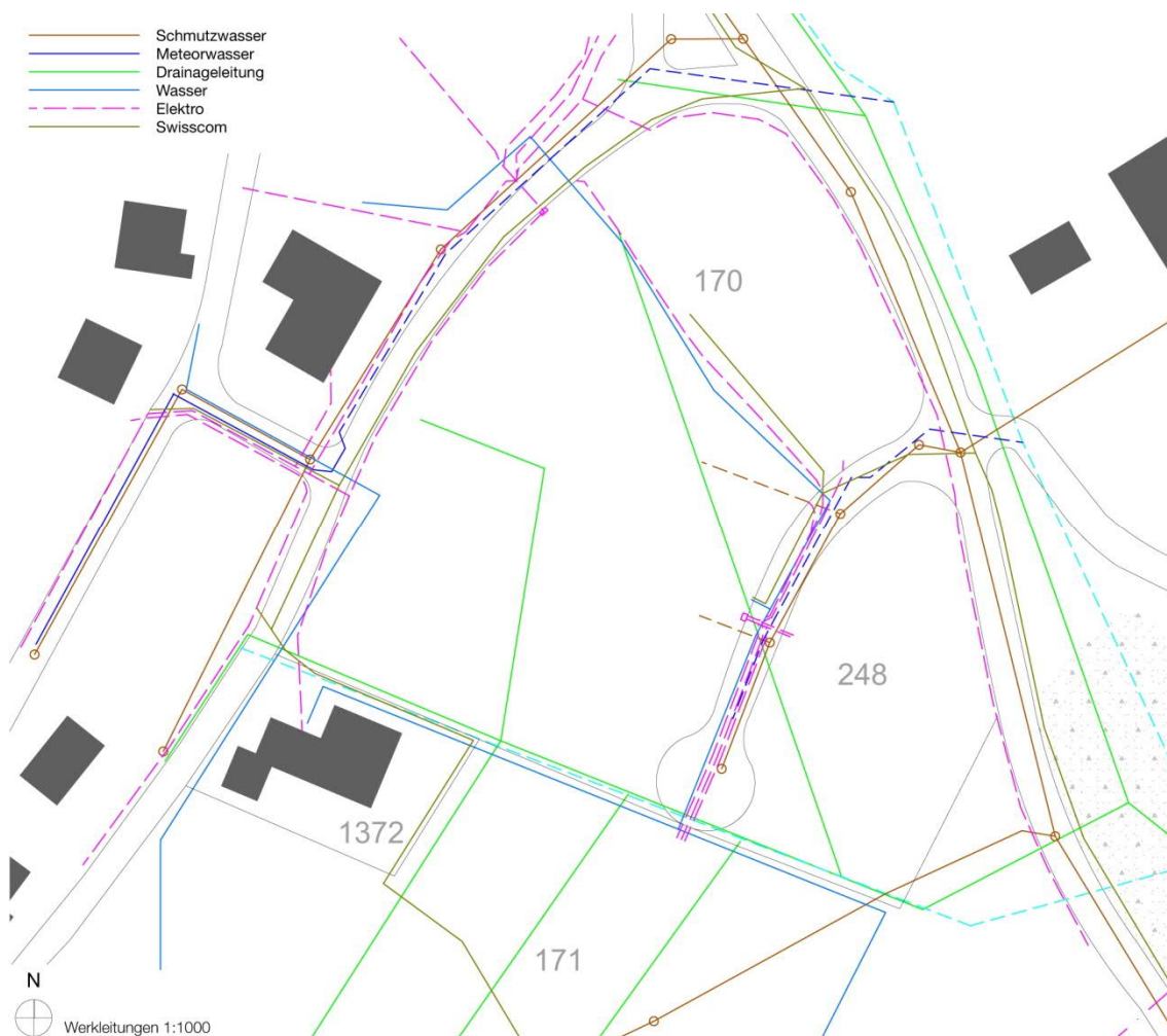
Abbildung 4 Bestehende Werk- und Drainageleitungen
